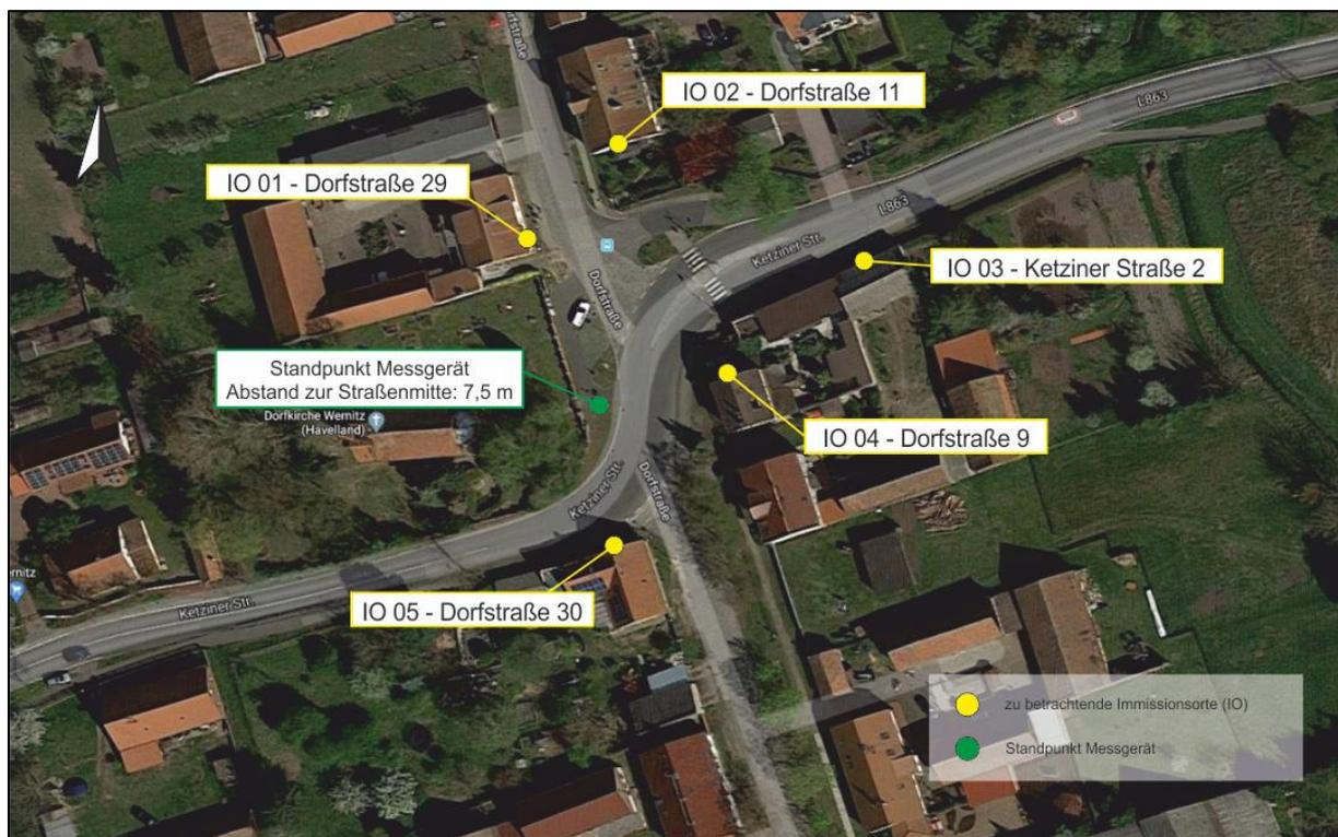
Abbildung 4 Lage des Messpunktes der Schallpegelmessungen und der maßgeblichen Immissionsorte für die schalltechnischen Berechnungen
