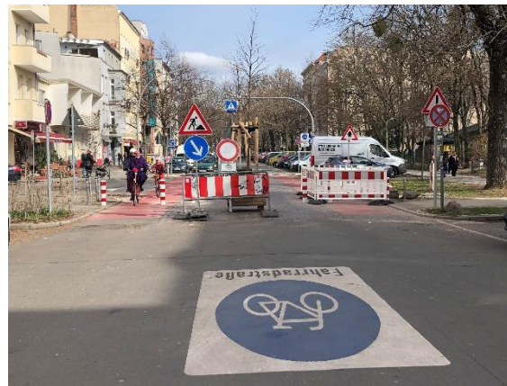
Abbildung 13 Fahrradstraße mit modularem Filter durch versenkbaren Poller in Berlin-Kreuzberg (Körtestraße)
