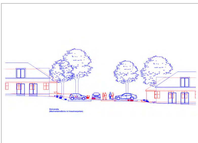
Abb. 37: Überlagerung Bestand (rot) und Konzept Straßenschnitt (blau)
